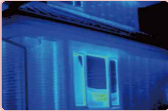
スモリの家 銀我パネルの輻射で室内の熱が外に逃げるため外壁の温度が低い
