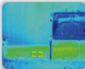
換気口のある基礎では冷たい空気が中に入り込みます。
